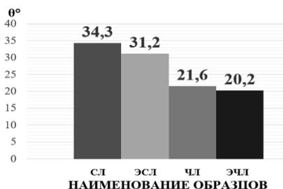
Рисунок 2 – Краевой угол смачивания бумажных фильтров водой
