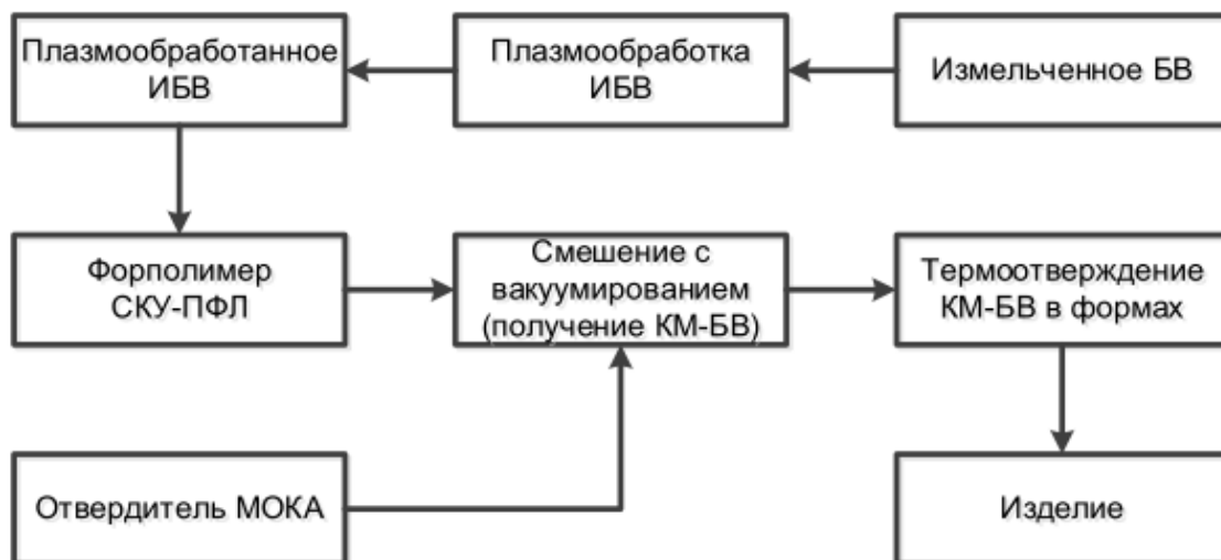
Рисунок 2 – Принципиальная технологическая схема получения КМ-БВ
