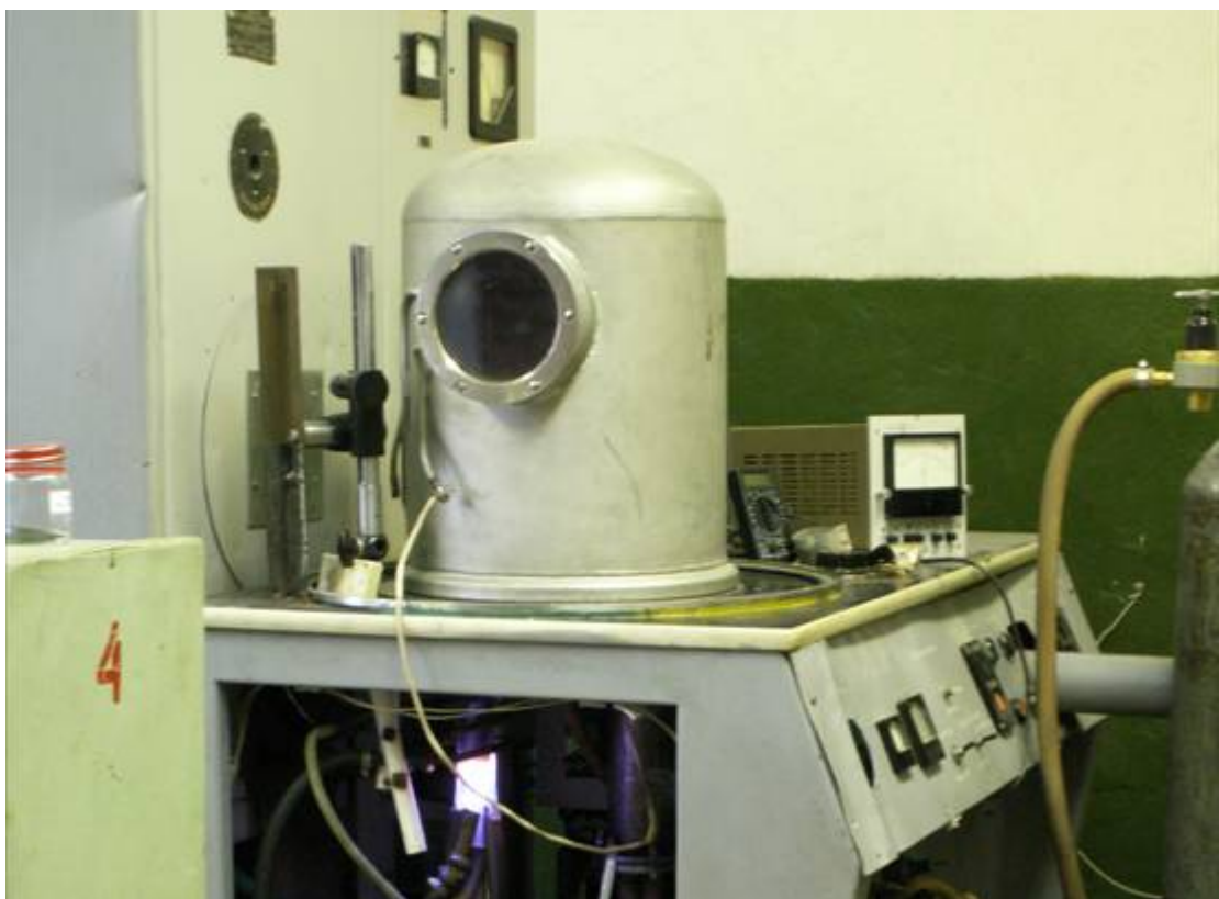
Рисунок 2.2 — Вакуумный блок установки для получения струйной ВЧИ-плазмы (ВЧИ-мед)
