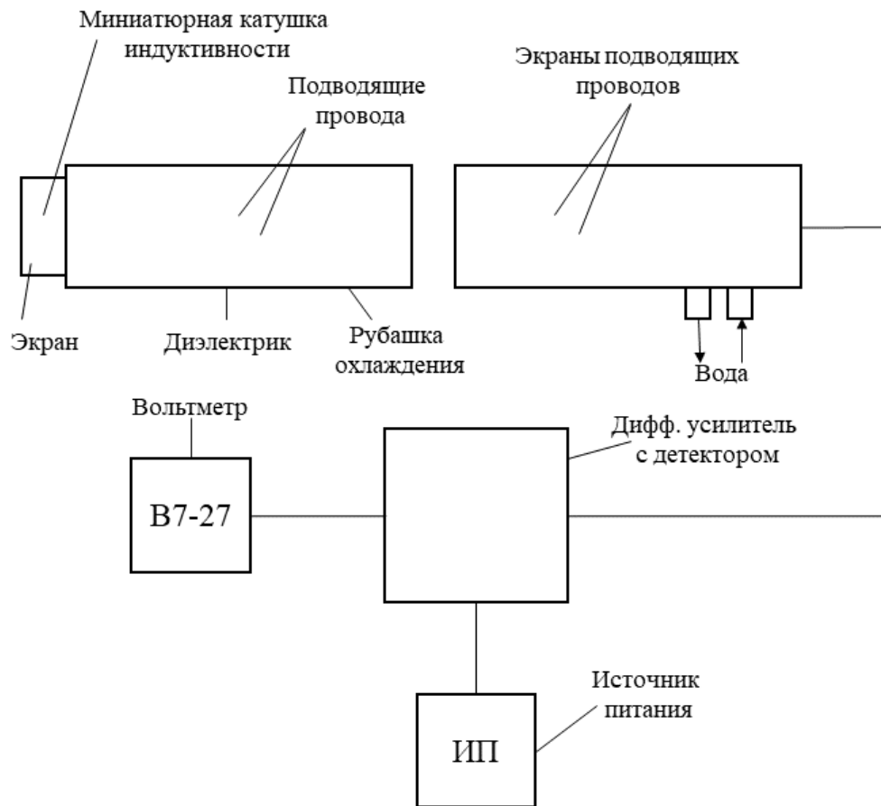
Рисунок 2.4 — Функциональная схема зонда для измерения магнитной составляющей электромагнитного поля в ВЧИ-разряде с продувом газа при пониженных давлениях.
