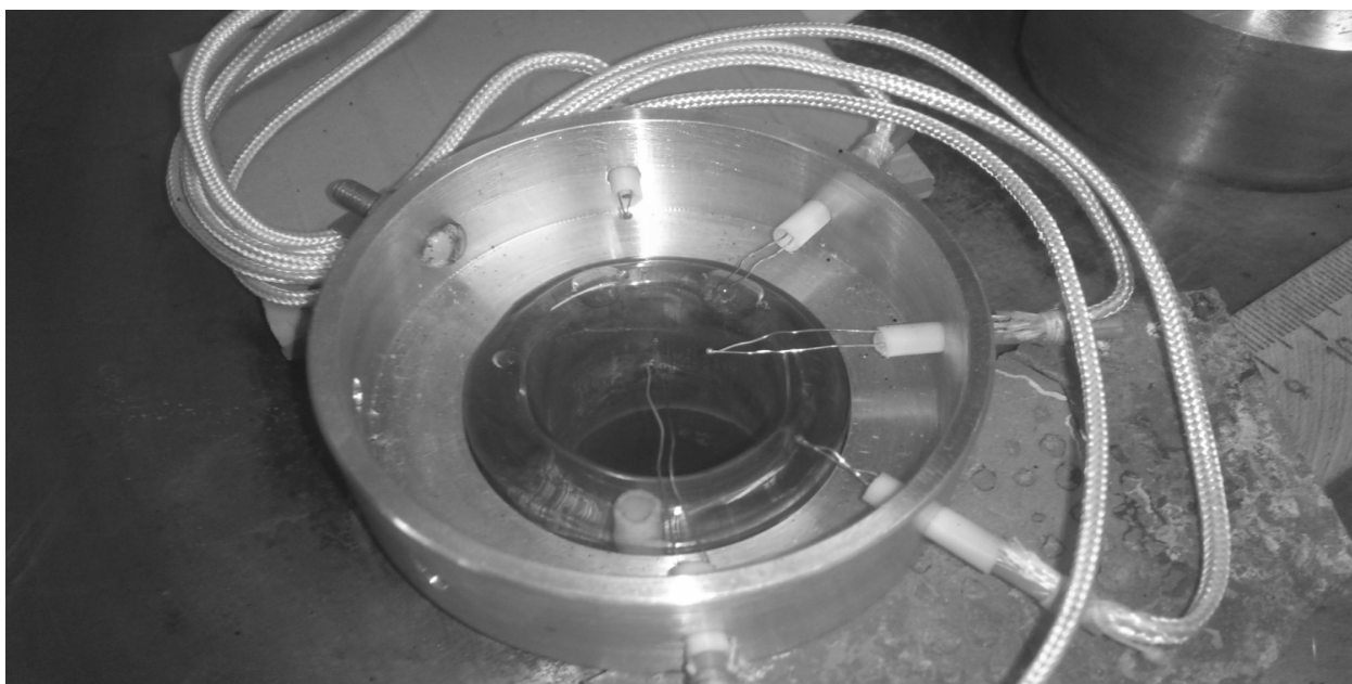
Рисунок 5.61 — Фланец с термопарами на ВЧИ-плазменной установке.
