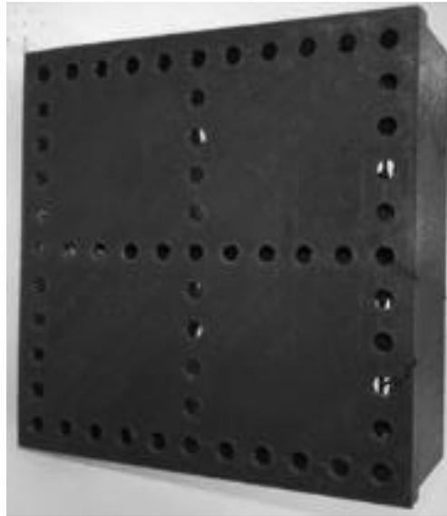
Рисунок 5.2 – Задняя крышка блочного мультивихревого сепаратора с отверстиями для выхода газа
