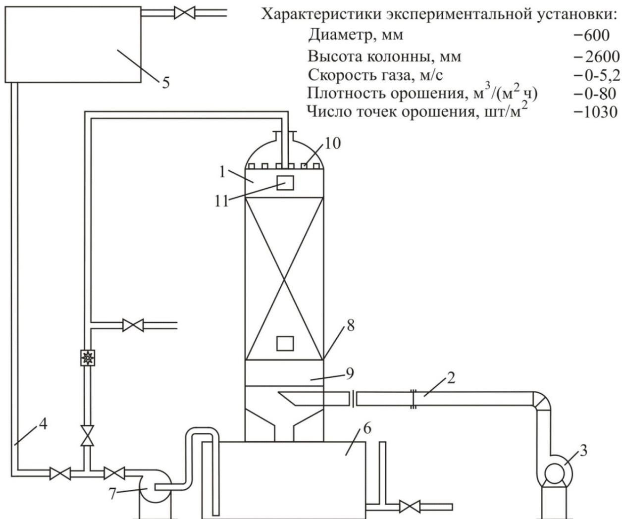
Рисунок 4.12. – Схема экспериментальной установки
