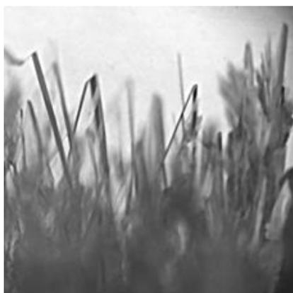
**Рис. 2.3.** Микрофотография кристаллов CdNTP, оптический микроскоп, увеличение 40×
