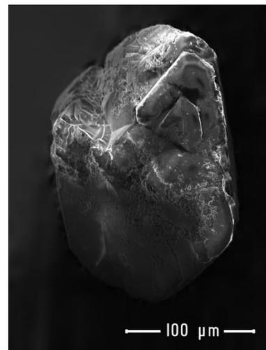
**Рис. 2.6.** Монокристалл FeCdNTP, сканирующий электронный микроскоп, увеличение 250×
