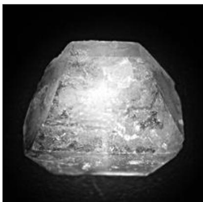
**Рис. 2.1.** Микрофотография кристалла ZnNTP, оптический микроскоп, увеличение 40×
