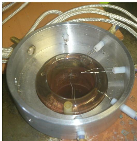
Рис. 7 — а) Радиальное распределение температуры  $T_a$  (на рис. обозн.  $T$  [K]) в поперечном сечении струи при наличии образца. Образец располагался на расстоянии  $L_{tb} = 0,2$  м от входного отверстия ( $R_{rk} = 0,012$  м,  $R_{vk} = 0,2$  м,  $L_{vk} = 0,5$  м,  $G = 0,16$  г/с,  $P = 2,4$  кВт,  $v_{inlet} = 440$  м/с). Точками обозначен эксперимент. б) Экспериментальный фланец с термопарами.
