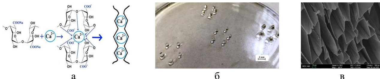
Рисунок 9 – Схематическое изображение гелеобразования АЛГ-На в присутствии ионов \text{Ca}^{2+} (а), гелевые сферы АЛГ-Са-ХТЗ, полученные способом 2 (б) и СЭМ-изображение внутренней структуры гелевого образца (в)
