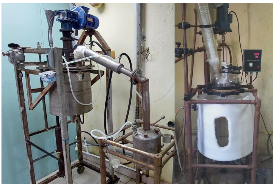
Рисунок 3.6.2.2– Детализация пилотной установки синтеза 4,4'-бифенола: (1) реактор Р-1, (2) стеклянный реактор Р-2.
