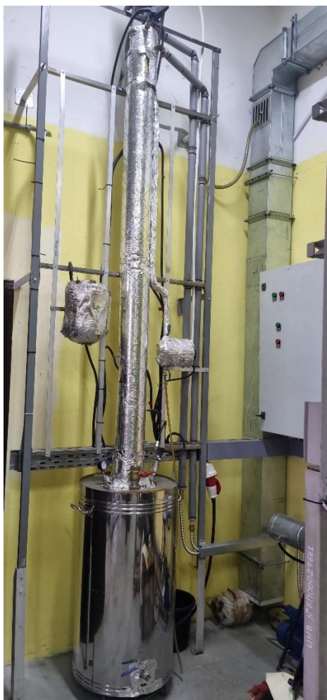
Рисунок 3.6.5.1 – Пилотная установка регенерации изопропилового спирта, толуола и выделения трет бутилхлорида методом ректификации
