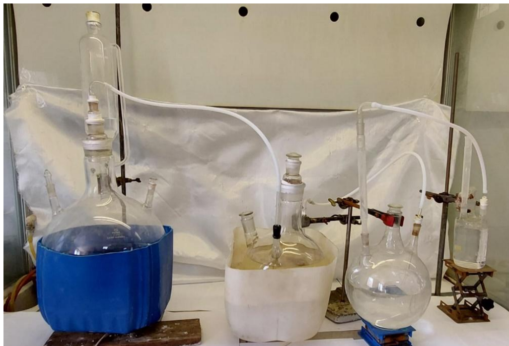
Рисунок 3.6.3.1 – Пилотная установка насыщения изопропилового спирта хлороводородом
