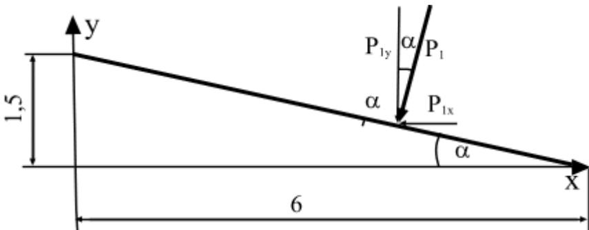
Рис. 3.9 Определение проекций на оси координат
