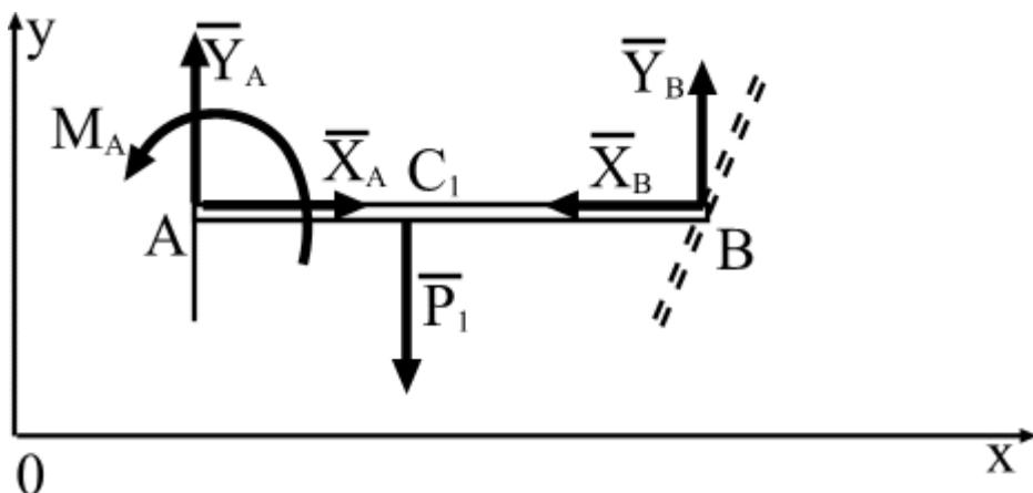
*Рис.3.6. Равновесие стержня АВ*
