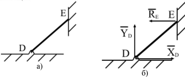
**Рис.1.7. Пример закрепления стержня на неподвижном шарнире**
