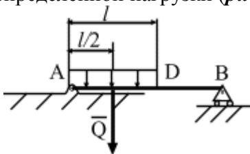
**Рис.2.5 Замена распределенной нагрузки  $q$  сосредоточенной силой  $Q = q \cdot l$**
