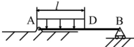
**Рис.2.4.** Схематическое представление распределенной нагрузки
