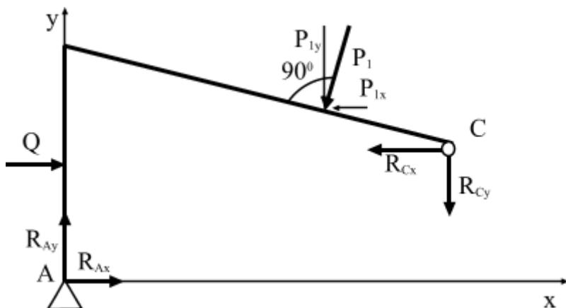
*Рис. 3.10. Силы, приложенные к левой части конструкции*
