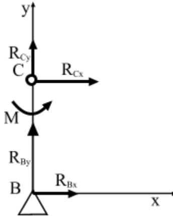
*Рис.3.11. Силы, приложенные к левой части конструкции*
