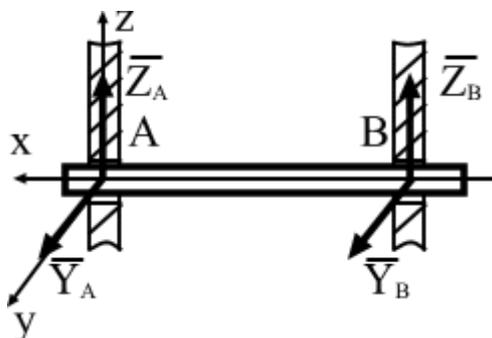
**Рис.1.12. Предполагаемое направление реакций подшипника**
