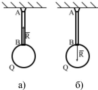
*Рис.1.4. Пример закрепления груза невесомым стержнем*
