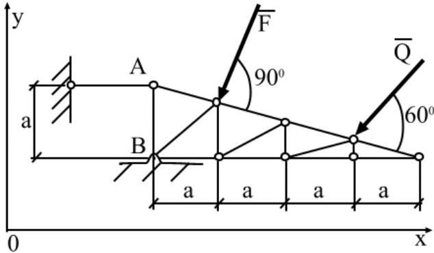
**Рис.2.9. Схематическое изображение фермы и действующих на нее сил**
