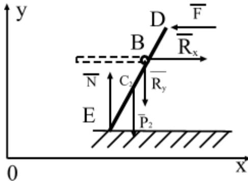
**Рис.3.5.** Схема равновесия стержня DE
