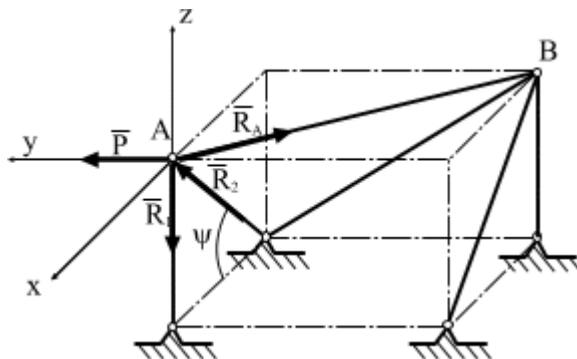
*Рис.4.4 Реакции стержней*
