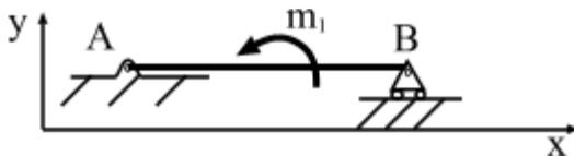
**Рис.2.6. Схематическое представление момента силы**
