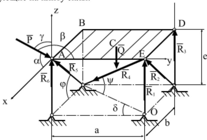
Рис.4.8. Плита и действующие на нее силы
