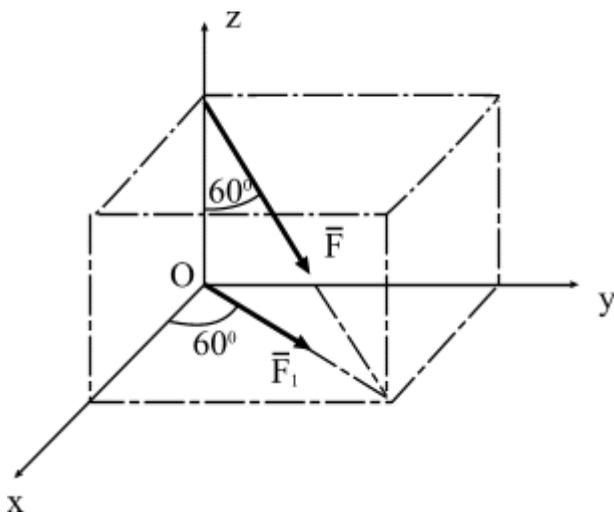
*Рис.4.2 Проекция силы  $\vec{F}$  на плоскость  $Oxy$*
