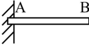
***Рис.1.9. Схематическое представление жесткой заделки***
