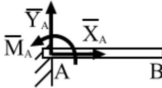
***Рис.1.10. Предполагаемые направления компонентов реакции опоры и неизвестного момента  $M_a$***
