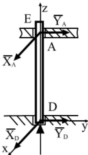
*Рис.1.13 Предполагаемое направление реакций подшипника*
