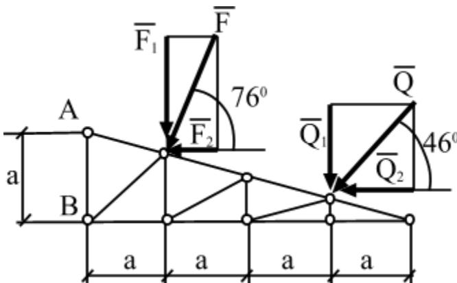
*Рис.2.10.Разложение сил на составляющие*
