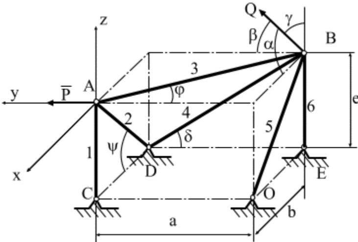
*Рис.4.3. Схема действия сил на конструкцию*
