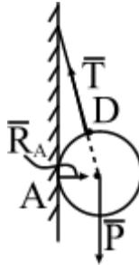
*Рис.1.3 Соединение гибкой нерастяжимой нитью*
