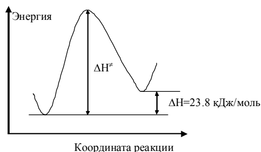
Рис. 63 – Энергетический профиль реакции нитро-нитритной перегруппировки нитрометана
