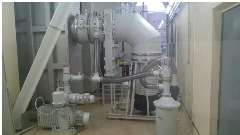
Рис. 2. Откачная система установки для дегазации солнечных батарей
