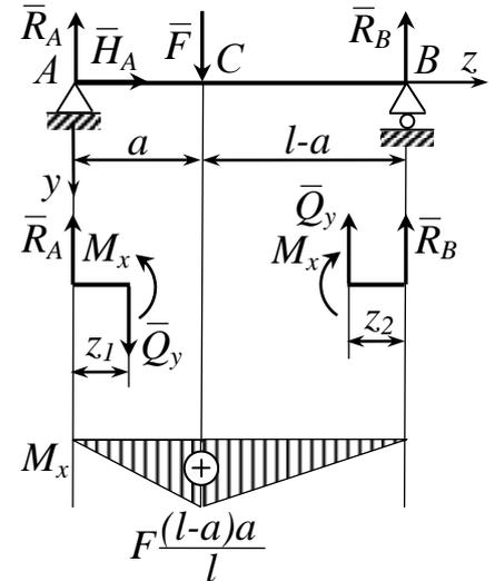
Максимальное значение  $M_x$  достигается в опасном сечении балки при  $z_1 = a$  или  $z_2 = l - a$  (индекс «2» указывает на 2-й случай):
