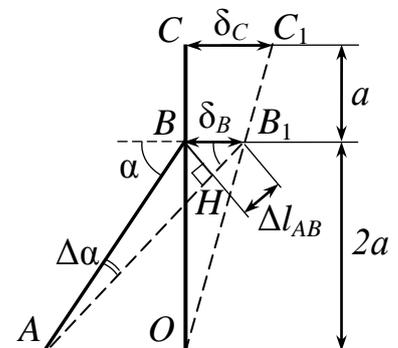
Обозначим через  $B_1$  и  $C_1$  положения точек  $B$  и  $C$  после приложения нагрузки  $\vec{F}$ . Так как по условию перемещение точки  $C$  при этой нагрузке мало по сравнению с длиной  $OC$ , то перемещения точек  $C$  и  $B$  (малые дуги окружностей с центром в
