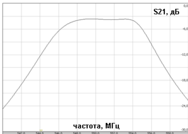
Рис. 5 – Экспериментальная АЧХ фильтра в ближней зоне
