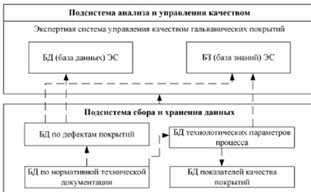
Рисунок 1 – Структура интеллектуальной системы обеспечения качества продукции (на примере гальванических покрытий).
