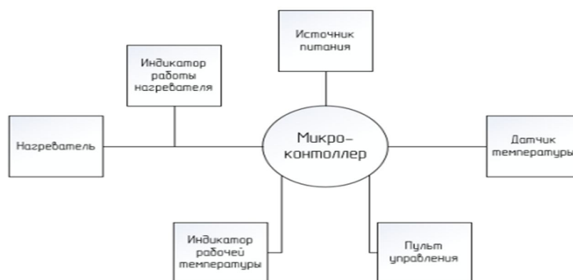
Рисунок 2 – Структурная схема средств технической автоматизации контроля температуры в помещении.
