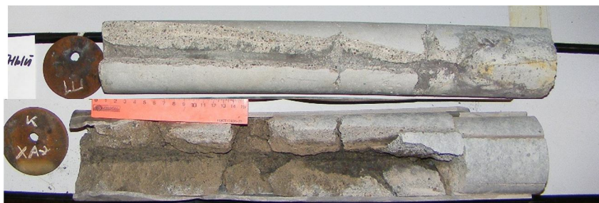
Рисунок 3 – Внешний вид комбинированных мишеней и пробитых каналов.
