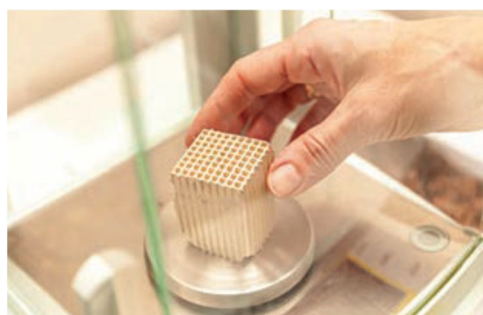
Рисунок 3 – Лабораторное тестирование катализатора подавления оксидов азота
