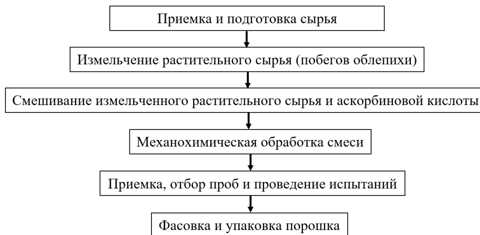
Рисунок 1.1 – Схема получения порошка с БАВ из побегов облепихи по методу Одинца А.Г.
