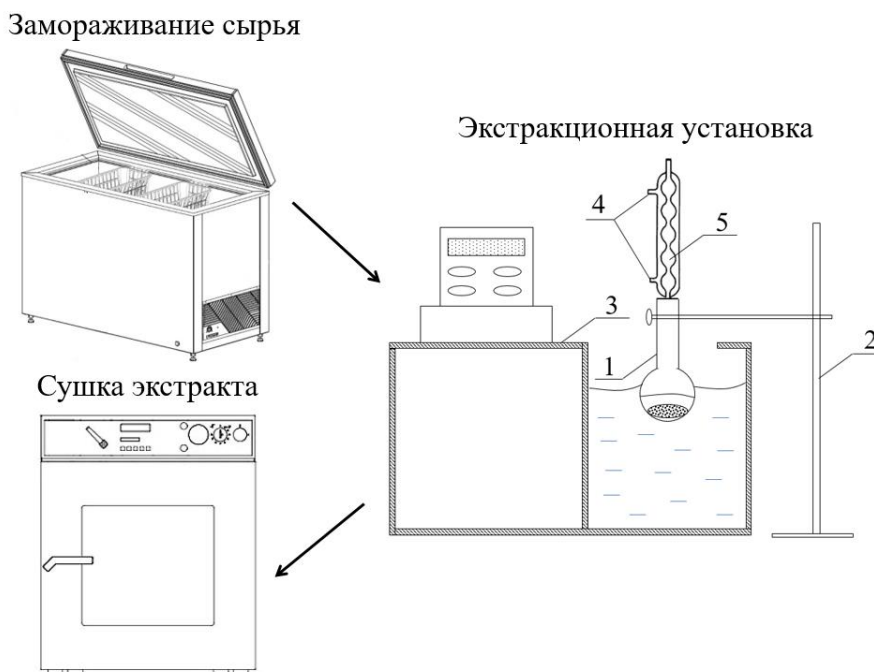
Рисунок 3.11 – Принципиальная схема экстракционной установки с замораживанием: 1 – толстостенный сосуд; 2 – штатив; 3 – жидкостной термостат; 4 – отводы конденсатора; 5 – конденсатор
