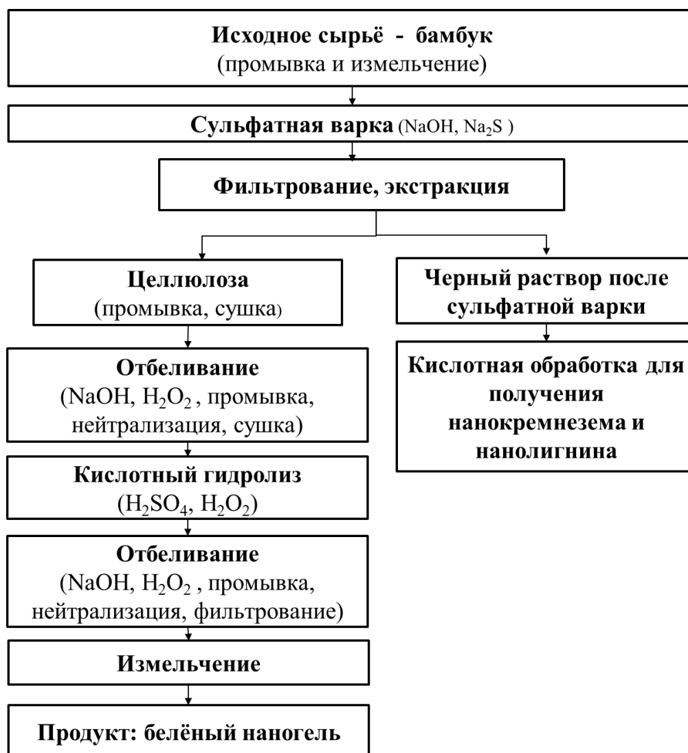
Рисунок 2.2 – Схема процесса изготовления наноцеллюлозы из бамбука
