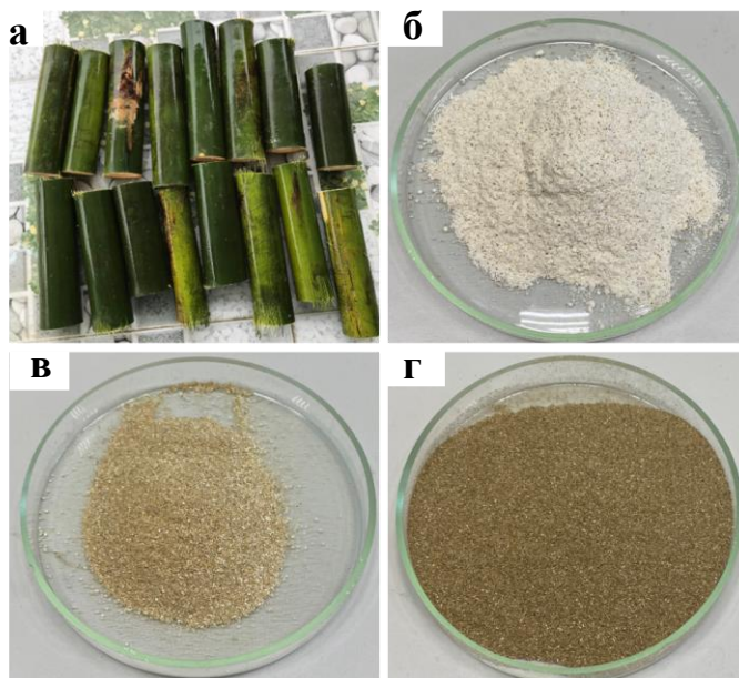
Рисунок 2.1 – Природные полимеры из Вьетнама: а – бамбук; б – порошок тапиоки; в – порошок соломы арахиса; г – порошок шелухи орехов арахиса
