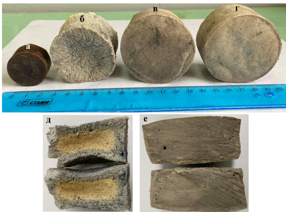
Рисунок 3.38 – Геометрические размеры ВНР до набухания (а) и после 120 суток экспозиции в дистиллированной воде (б,в,г,д,е) на основе смеси НК/Na-КМЦ/НЦ (% мас.), полученных: б – 50/50/0 методом твердофазного смешения; в – 50/50/0, г – 50/48/2 методом жидкофазного совмещения; д – поперечное сечение образца б, е – поперечное сечение образца г
