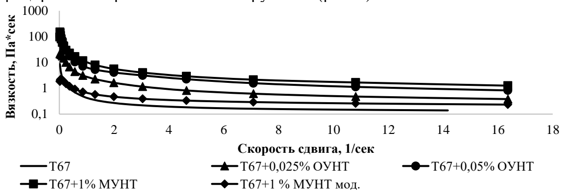
Рисунок 1 – Зависимость вязкости от скорости сдвига при различных концентрациях модификаторов
