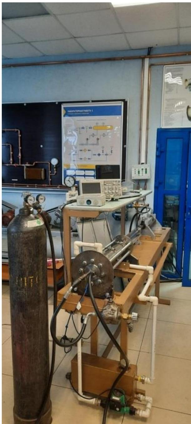
Рисунок 4.21 – Фотография стенда при моделировании работы второй ступени сжатия
