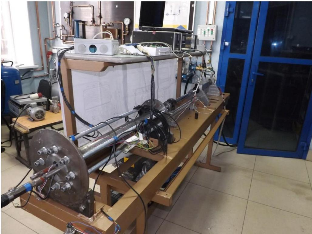
Рисунок 4.16 – Стенд с расположенными по длине цилиндра тензодатчиками
