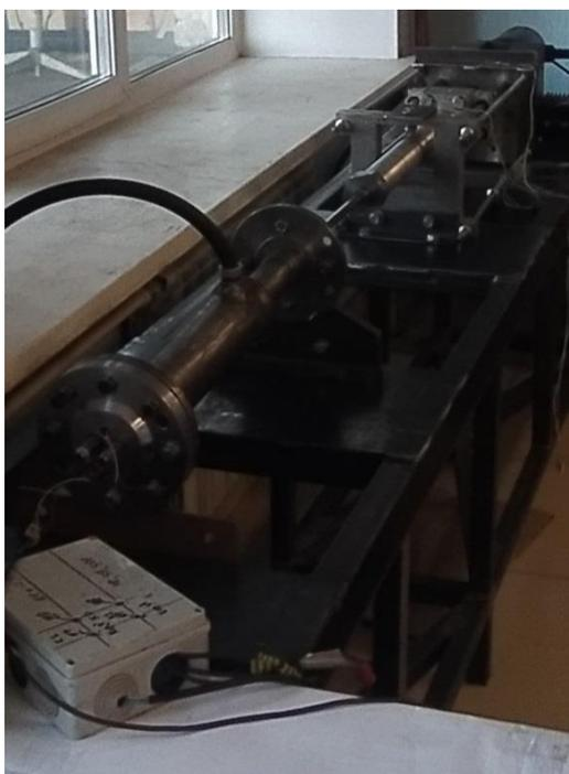
Рисунок 9.13 – Конструкция тихоходного агрегата с электромеханическим приводом
