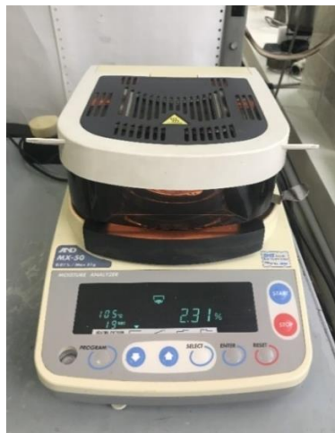
Рисунок 2.6 – Термогравиметрический анализатор влажности AND MS-70
