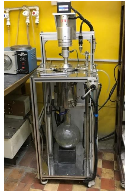
Рисунок 3.1 – Установка для высокотемпературного гидролиза с кольцевым обогревателем и сливом: а) принципиальная схема: 1 – сосуд гидролизера; 2 – магнитная мешалка; 3 – стакан для сырья; 4 – термопара внутри стенки; 5 – термопара внутри гидролизера; 6 – сливной кран; 7 – предохранительный разрывной клапан; 8 – крышка гидролизера; 9 – якорь магнитной мешалки; 10 – сита; 11 – блок управления; 12 – змеевик; 13 – патрубок входа; 14 – патрубок выхода; 15 – электронагреватель; 16 – стол; 17 – сосуд для слива гидролизата; б) общий вид установки
