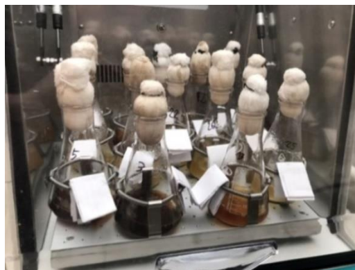
Рисунок 3.11 – Процесс культивирования ксантана на гидролизатах древесного сырья
