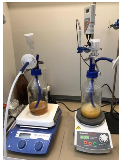
Рисунок 3.14 – Лабораторная установка для ферментации: а) принципиальная схема: 1 – лабораторная бутылка; 2 – якорь магнитной мешалки; 3 – крышка GL 45 с тремя штуцерами; 4 – фильтр; 5 – компрессор; 6 – аэратор; 7 – гидрозатвор; 8 – штуцер для подвода стерильного воздуха; 9 – штуцер для отвода излишков воздуха и газообразных продуктов ферментации; 10 – штуцер для загрузки компонентов; 11 – зажим; 12 – магнитная мешалка; б) общий вид лабораторной установки
