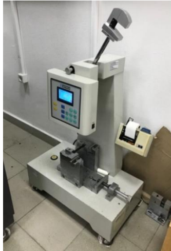
Рисунок 4.11 – Маятниковый копер для определения ударной вязкости UGT-7045-MDL
