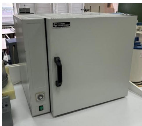
Рисунок 3.12 – Сушильная камера лабораторная СНОЛ – 67/350
