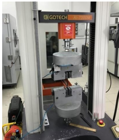
Рисунок 4.8 – Универсальная испытательная машина Gotech AI -7000M
