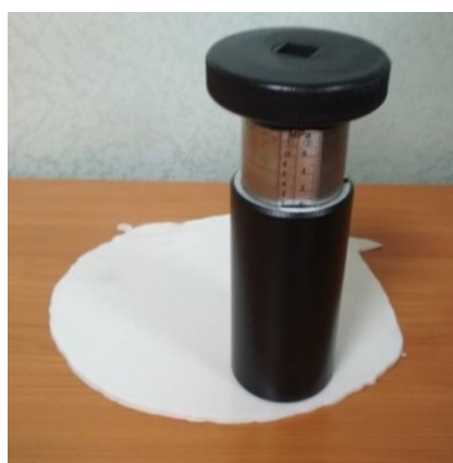
Рисунок 5.4 – Определение адгезии методом отрыва: а) адгезиметр Константа АЦ; б) зависимость разрывного усилия от состава композитного материала
