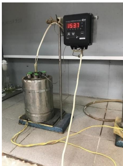
Рисунок 2.4 – Гидролизер капсульного типа с нагревательной электрорубашкой
