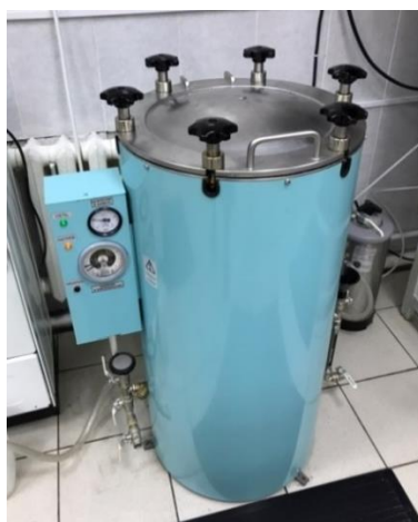
Рисунок 3.9 – Стерилизатор паровой ВКа-75-ПЗ
