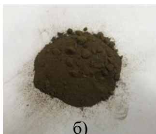
Рисунок 4.2 – Образцы наполнителей: а) древесная мука из древесины сосны; б) целлолигнин, полученный в результате процесса гидролиза; в) смесь из древесной муки и целлолигнина
