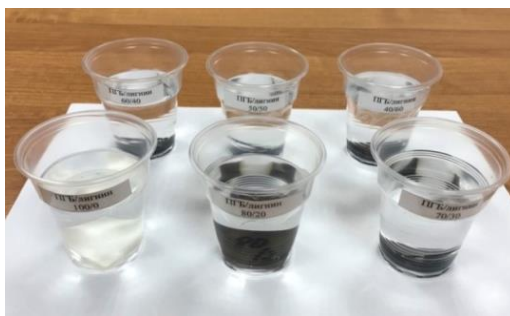
Рисунок 4.14 – Процесс исследования на водопоглощение композитного материала
