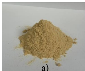
Рисунок 4.2 – Образцы наполнителей: а) древесная мука из древесины сосны; б) целлолигнин, полученный в результате процесса гидролиза; в) смесь из древесной муки и целлолигнина
