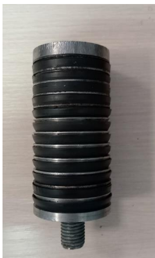
Рисунок 3.21 – Наборный манжетный поршень с 12-ю манжетными уплотнениями
