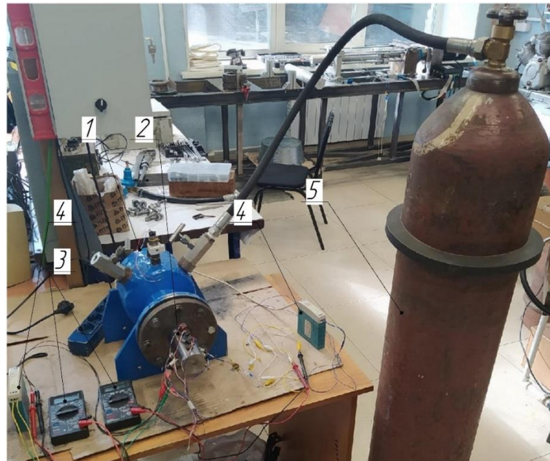
Рисунок 3.17 – Общий вид экспериментального стенда: 1 - ёмкость, 2- блок наборного поршня, 3- мультиметры, 4- блок питания, 5- баллон со сжатым воздухом
