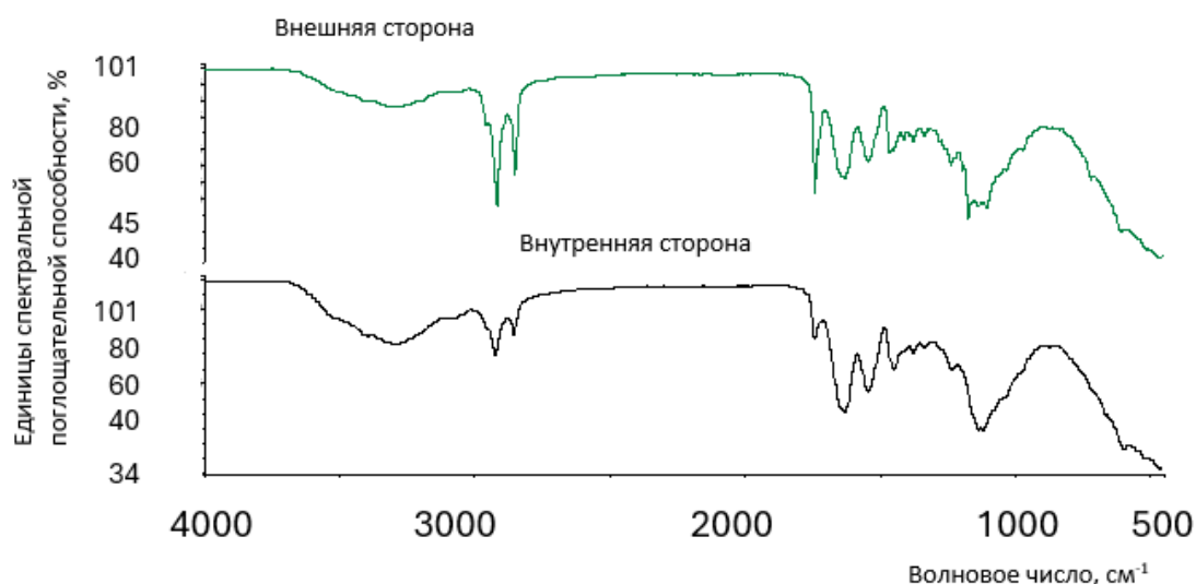
Рисунок 4.44 – ИКС профиль опытного образца кожи из ШР сазан
