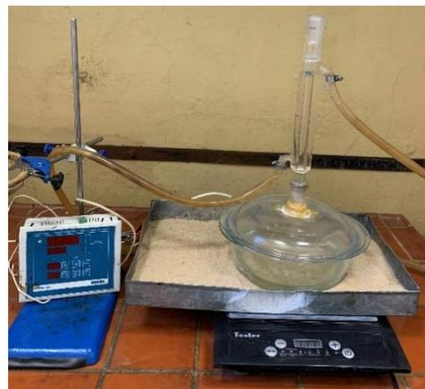
Рисунок 3.2 – Установка для пропитки бересты берёзы: а) принципиальная схема; б) внешний вид установки: ванна – 1; крышка ванны – 2; обратный холодильник – 3; датчики температуры – 4 и 5; регулятор температуры – 6; буферная ёмкость с песком – 7; индукционная плита – 8.
