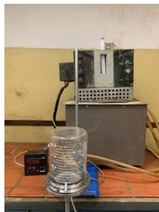
Рисунок 3.3 – Установки для определения массопроводности бересты берёзы: а) принципиальная схема; б) внешний вид установки: верхняя ёмкость с толуолом – 1; термостат с регулятором температуры – 2; образец бересты – 3; датчик концентрации толуола – 4; нижняя ёмкость – 5
