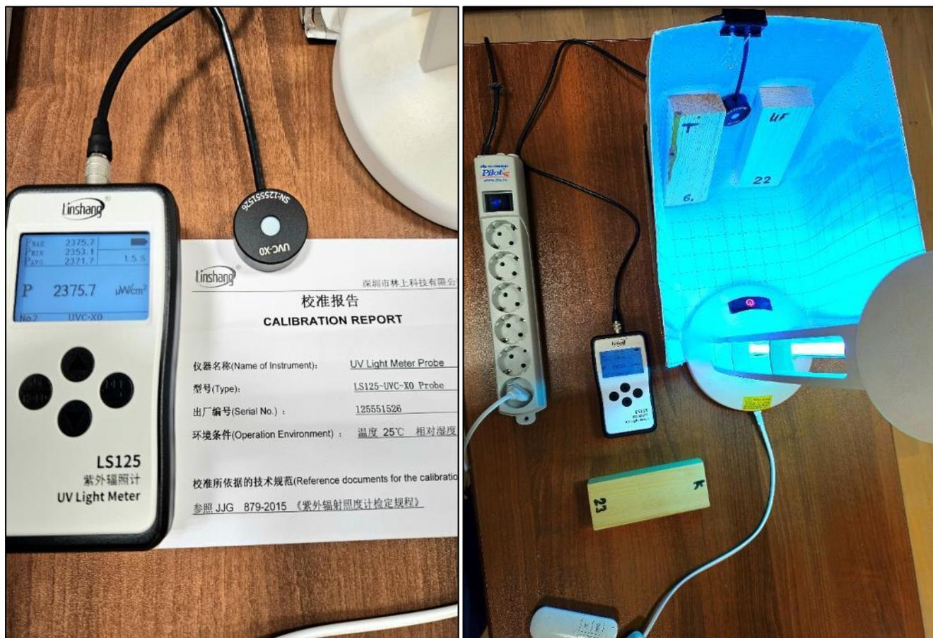
Рисунок 3.3 – Инструментальный контроль УФ обработки образцов
