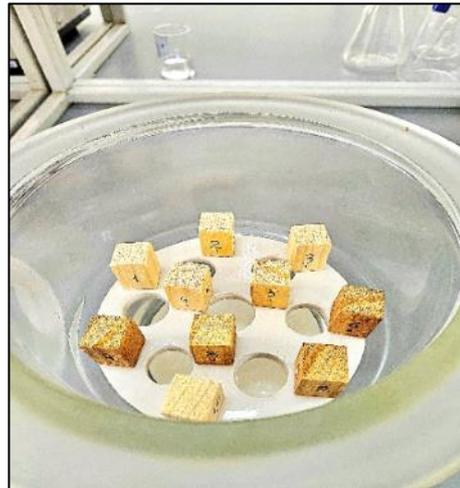
Рисунок 4.1 – Схема и внешний вид устройства для определения влагопоглощения образцов:
