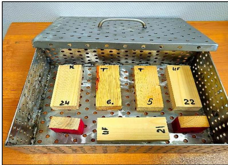
Рисунок 2.3 – Контейнер для термомодифицирования образцов
