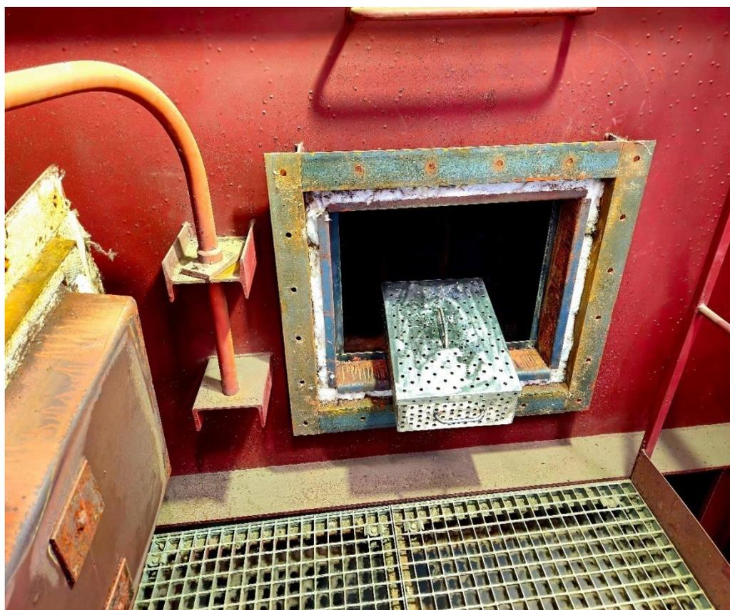
Рисунок 2.4 – Модуль для загрузки образцов для ТМД
