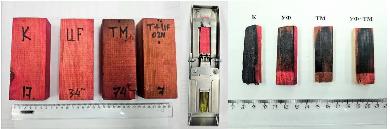
Рисунок 4.6 – Проведение испытаний древесины на огнестойкость
