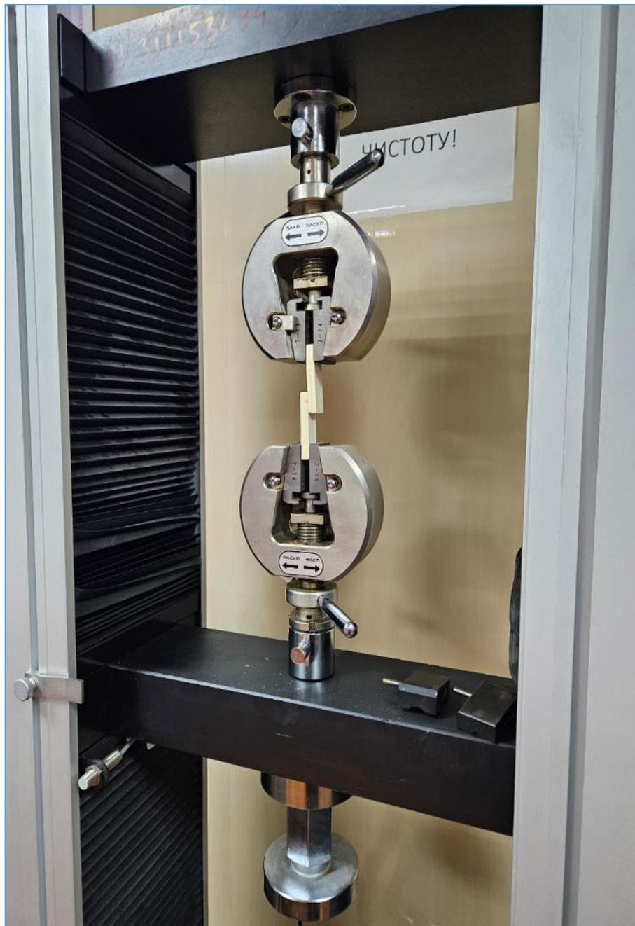
Рисунок 4.8 – Испытательная машина РКМ-300.2
