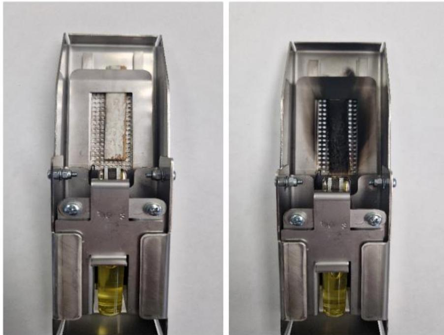
Рисунок 4.5 – Внешний вид прибора ПМП-1 с образцами древесины до и во время проведения испытаний
