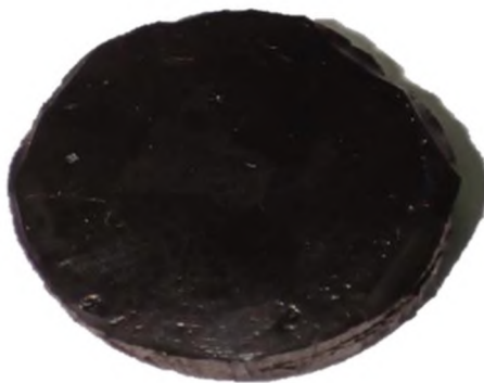
Рисунок 66 – Восстановившийся образец витримера
