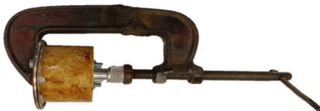
Рисунок 65 – Прессование измельченного образца в пресс-форме
