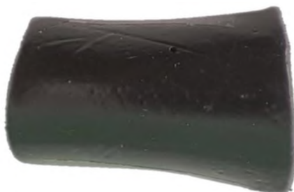
Рисунок 63 – Образец с восстановившейся поверхностью
