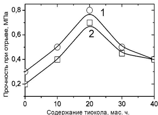
Рисунок 9 – Зависимости прочности при отрыве композиций БНК к стали (1) и дюралюминию (2) от содержания тиокола
