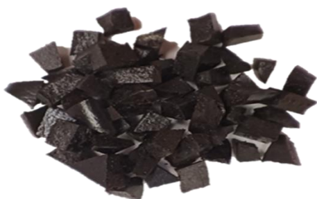
Рисунок 7 – Измельченный образец на основе смеси БНК и тиокол
