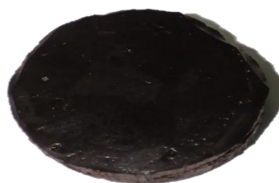
Рисунок 8 – Восстановившийся образец на основе смеси БНК и тиокол
