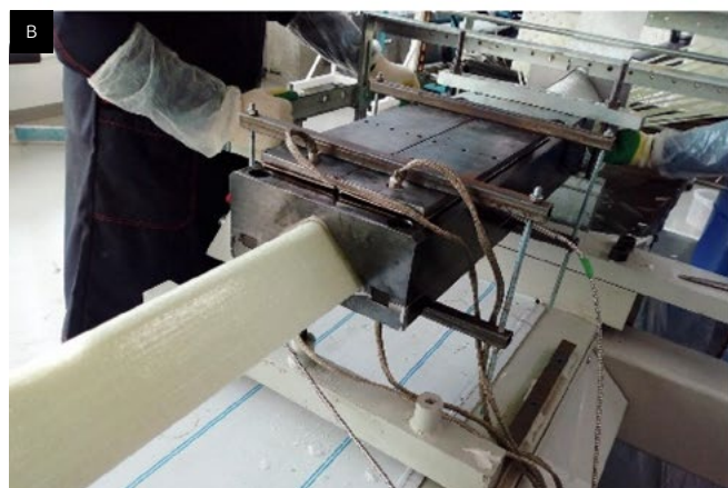
а) Размещение ткани и UD-армирования перед вводом в фильеру; б) Фильеры во время пултрузии; в) Отвержденный композит, выходящий из фильеры; г) Профили, изготовленные при исследованных скоростях вытягивания 200, 400 и 600 мм/мин.
