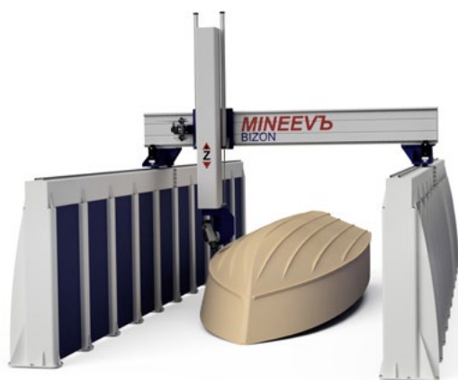
Фрезерный ОЦ MINEEV Bizon AP. Максимальные габариты заготовки: 4000x12000x2200 мм (XYZ)
