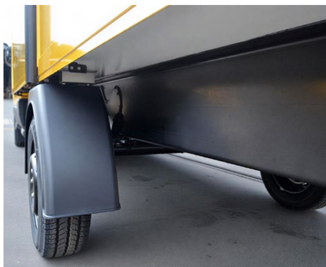
Углепластиковое шасси, изготовленное по технологии пултрузии, на 60% легче, чем аналогичные стальные конструкции. Фото: CarbonTT
