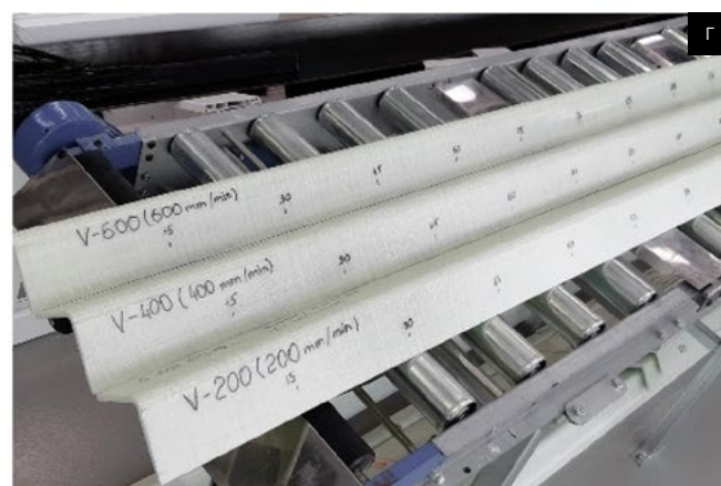
а) Размещение ткани и UD-армирования перед вводом в фильеру; б) Фильеры во время пултрузии; в) Отвержденный композит, выходящий из фильеры; г) Профили, изготовленные при исследованных скоростях вытягивания 200, 400 и 600 мм/мин.
