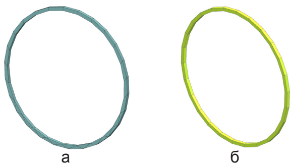
Рисунок 9 – Гексаэдральные 3D конечно-элементные модели геометрии для в виде пластины: а – модель для ПК ЛОГОС, б – модель для NX Nastran
