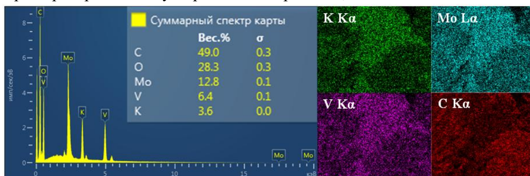
Рис. 7. Карта распределения элементов для изображения СЭМ поверхности катализатора \text{KVMoO}_6 после синтеза с коллагеном
