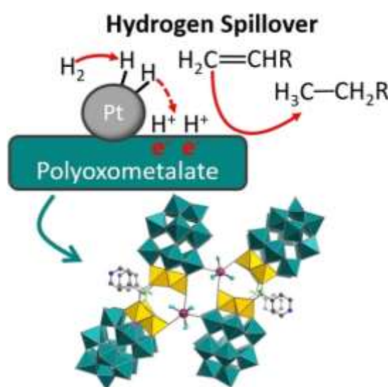
Рисунок 1.6 – Схематическое изображение предполагаемого механизма гидрирования с помощью катализатора Pt/Ce-ПОМ [60]
