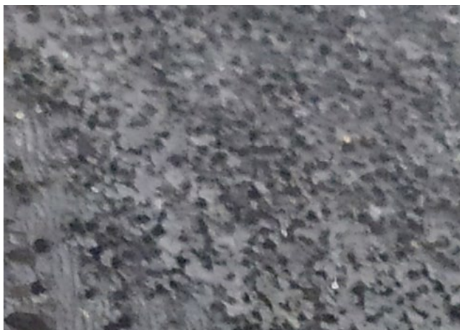
Рис. 1. Макроструктура поризованного силикон-графенового композита
