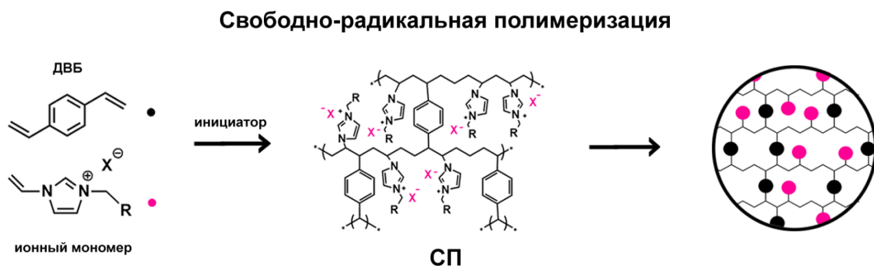
Рис. 22. Общая схема синтеза ионных сшиты полимеров (СП).
