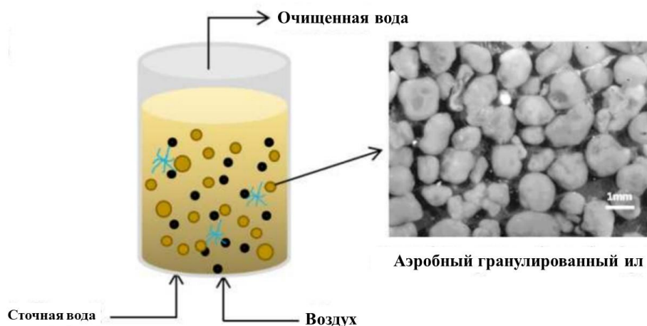
Рисунок 1.20 – Принципиальная схема реактора с гранулированным активным илом
