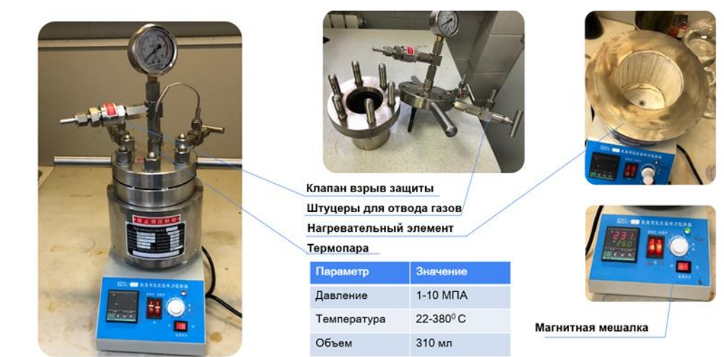
Рисунок 2.1 – Реактор для гидротермального ожижения осадков сточных вод и избыточного активного ила
