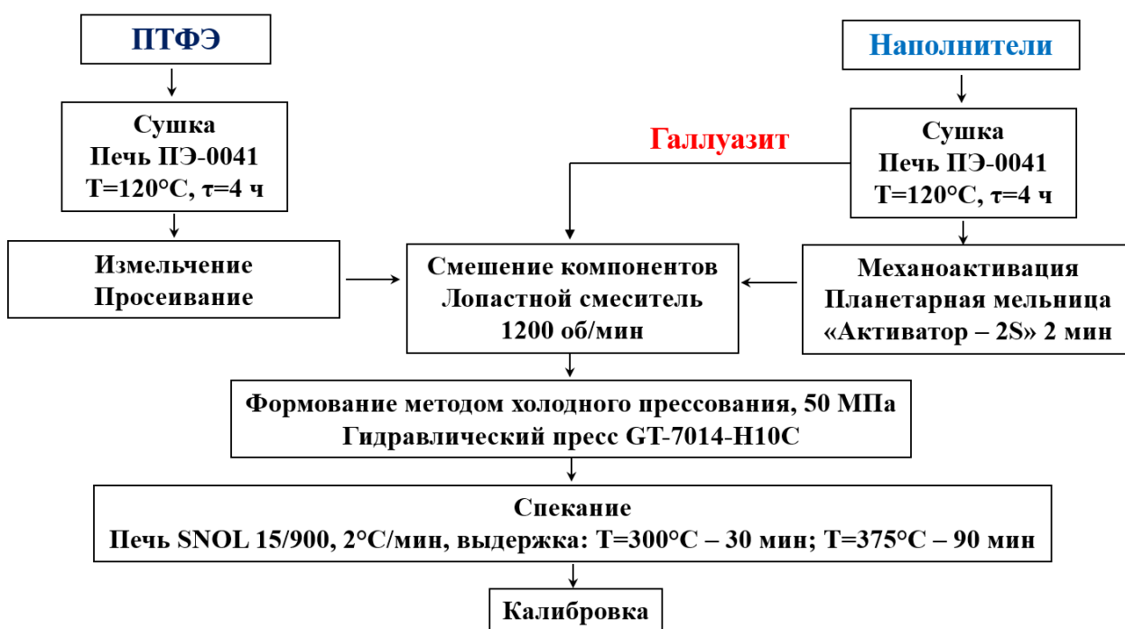
Рисунок 15 – Технологическая схема изготовления ПКМ на основе ПТФЭ
