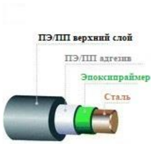
Рисунок 1.4 - Схема многослойной системы покрытия труб из полиолефинов [5]
