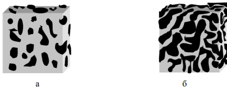
Рисунок 1.1 - Типы фазовой структуры двухфазных смесей полимеров: а - обычная дисперсия; б - структура с двумя непрерывными фазами
