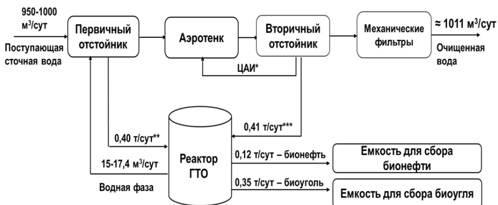
Рисунок 11 – Принципиальная технологическая схема БОС г. Иннополис с реактором ГТО, * циркулирующий активный ил (ЦАИ), **осадок первичного отстойника, ***осадок вторичного отстойника
