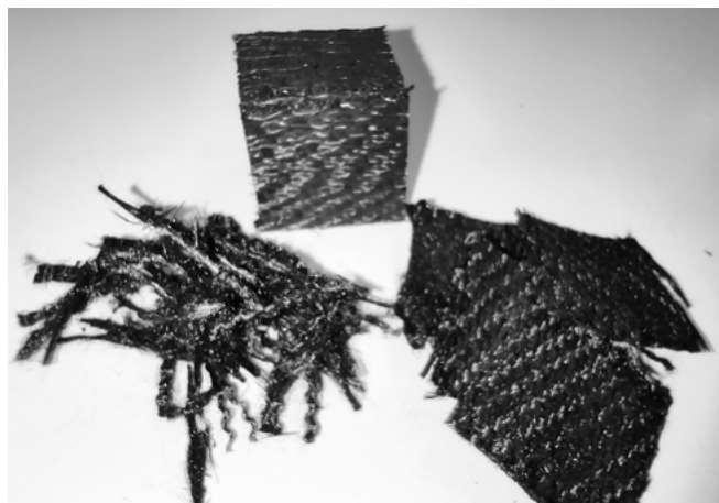
Рисунок 3. Внешний вид углепластика после температурной обработки при 600^{\circ}\text{C} в инертной среде
