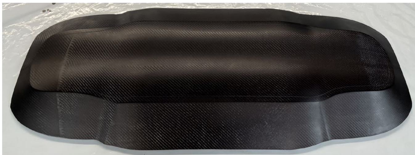
Рисунок 3. композитная оснастка на связующем «Резикарб Молд»
