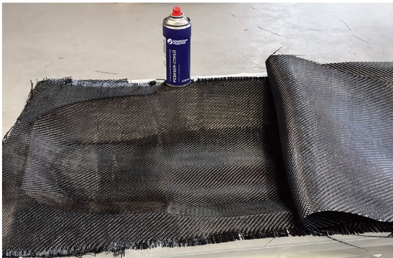
Рисунок 1. Выкладка сухой ткани с помощью клея «Резивер-спрей»
