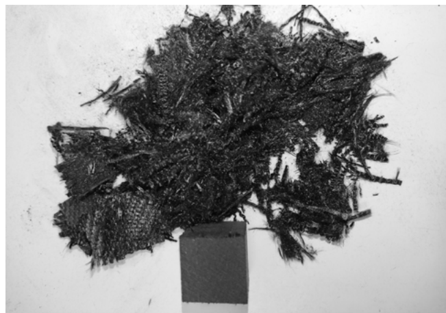
Рисунок 4. Внешний вид углепластика до пиролизной обработки (а) и выделенного углеродного волокна после высокотемпературной обработки при 900^{\circ}\text{C} (б), загрязненного коксовыми продуктами
