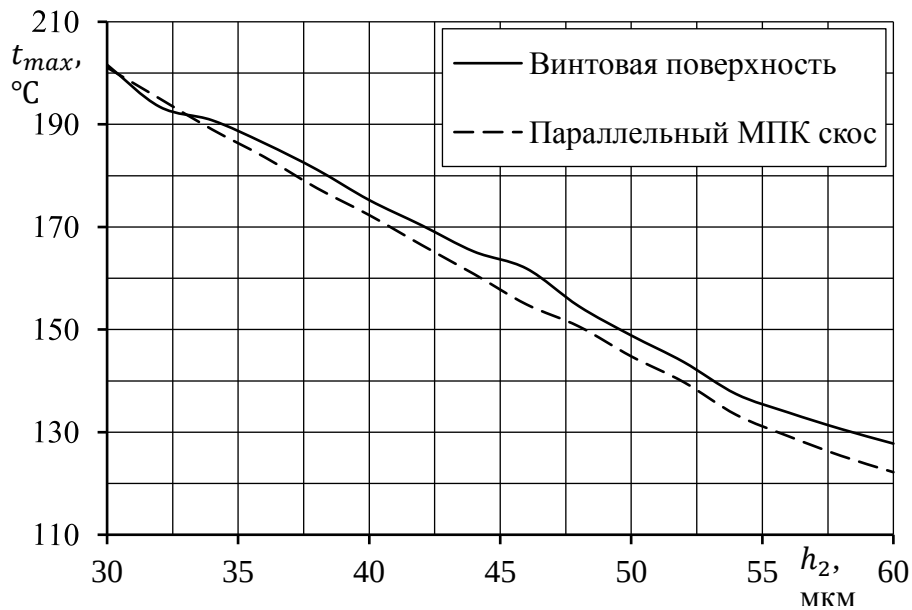
Рисунок 5.53 – Повышение максимума температуры смазки t_{max} при уменьшении высоты зазора подшипника двух профилей рабочей поверхности, n = 15000 \text{ мин}^{-1} , ширина скоса \eta_k = 26,7 \text{ мм}
