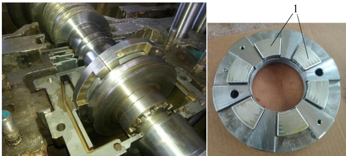
Рисунок 1.33 – Опорно-упорный подшипник конструкции СКБ по компрессоростроению согласно СТП 26-05-02-203-73, применяемый в АО «НИИтурбокомпрессор им. В. Б. Шнеппа»
