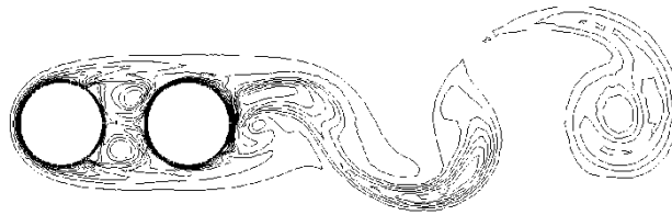
Рисунок 3.27 – Линии тока при докритическом и посткритическом режиме при Re = 4 \cdot 10^4 a ) G=4 ; b ) G=10
