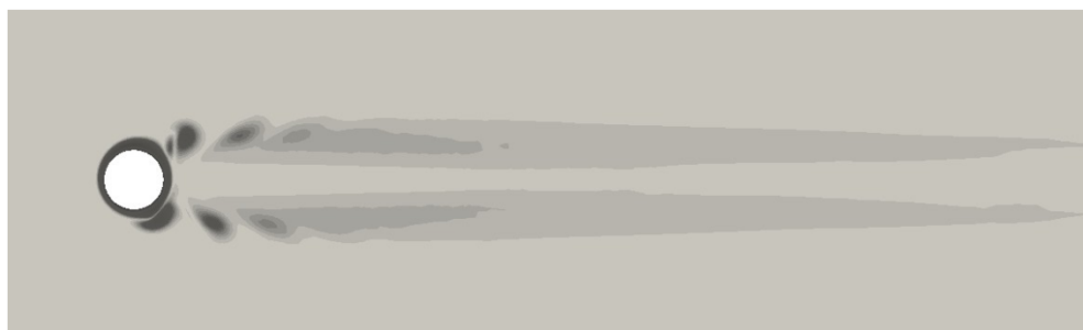
Рисунок 3.10 – Мгновенное поле завихренности в случае обтекания вязкой жидкостью осциллирующего цилиндра при \alpha_\varphi = 4 , f = 4
