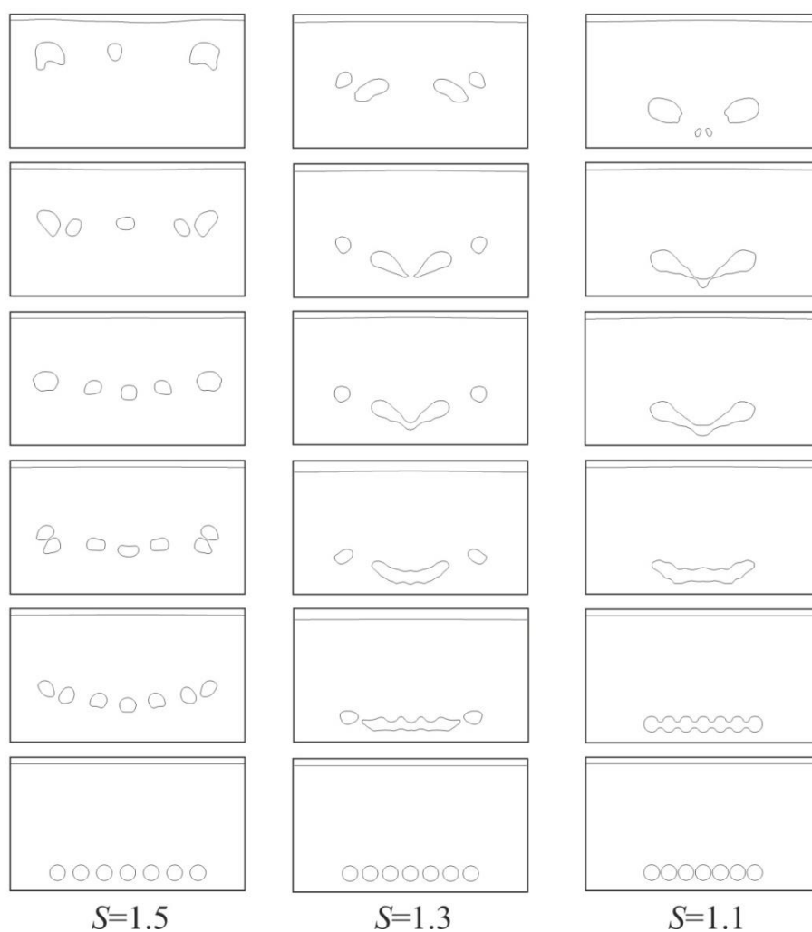
Рисунок 6.18 – Взаимодействие пузырьков в процессе всплытия
