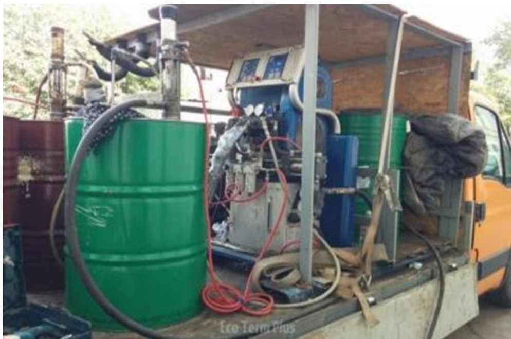
Рисунок 5.3 – Мобильный комплекс быстрого реагирования для изготовления Гринсорб Х
