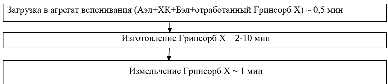
Рисунок 5.4 – Блок-схема технологического процесса получения Гринсорб Х в режиме быстрого реагирования
