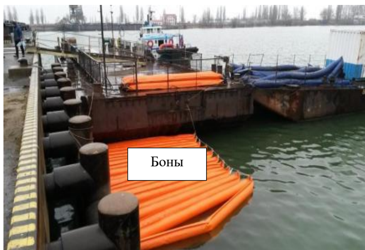
Рисунок 5.2 – Боны, наполненные сорбционным материалом Гринсорб Х
