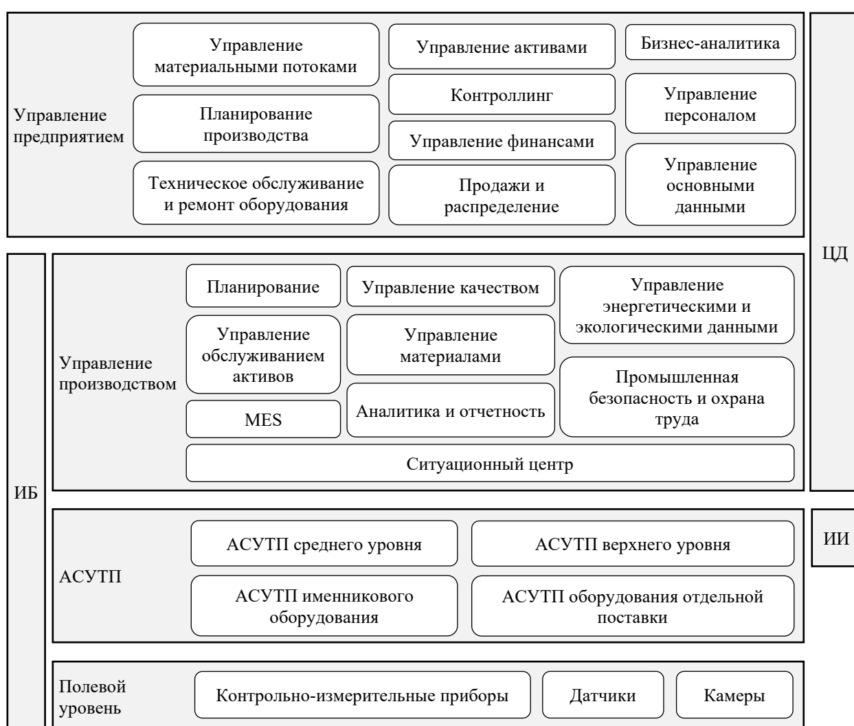
Рисунок 2.1 – Структурные элементы модели «цифровой фабрики» алюминиевого производства (обобщено автором)
