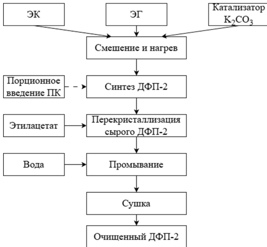
Рисунок 3.1 – Блок-схема технологического процесса получения ДФП-2
