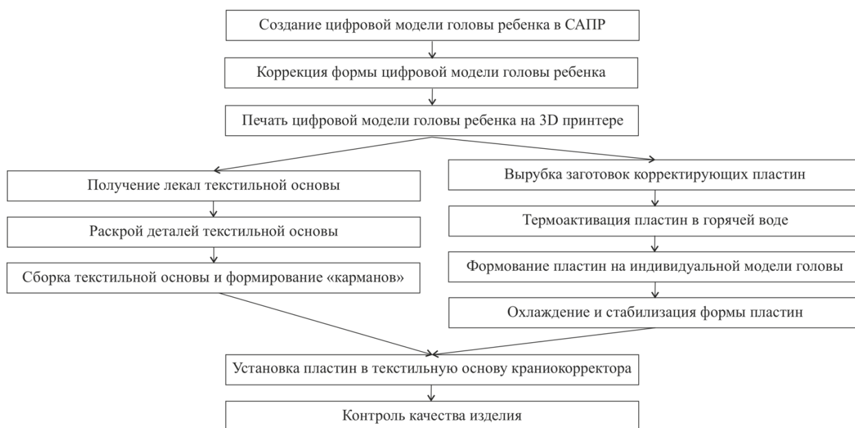
Рисунок 4.9 – Схема технологического процесса изготовления модульной адаптируемой конструкции ортопедического шлема
