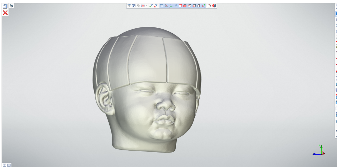
Рисунок 4.4 – Полученная в программе «T-FLEX CAD» пространственная форма ортопедического шлема с выделенными деталями
