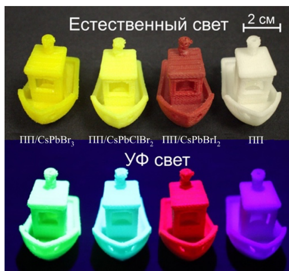
Рисунок 4.23 – Модели, изготовленные методом 3D-печати из полученной композиции: под естественным светом и УФ-светом
