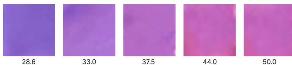
Рисунок 3.11 – Фотографии образцов ТГФТ/Еи с различной концентрацией соли (мас.%) под УФ-излучением
