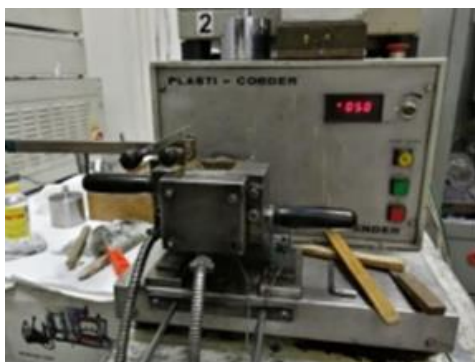
Рисунок 4.5 – Смеситель типа Brabender (a); полученный композит (б) состава ПВД + ДМ
