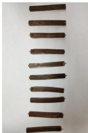
Рисунок 4.6 – Инжекционная литьевая машина для пробоподготовки (a); полученные образцы в виде брусков (б)
