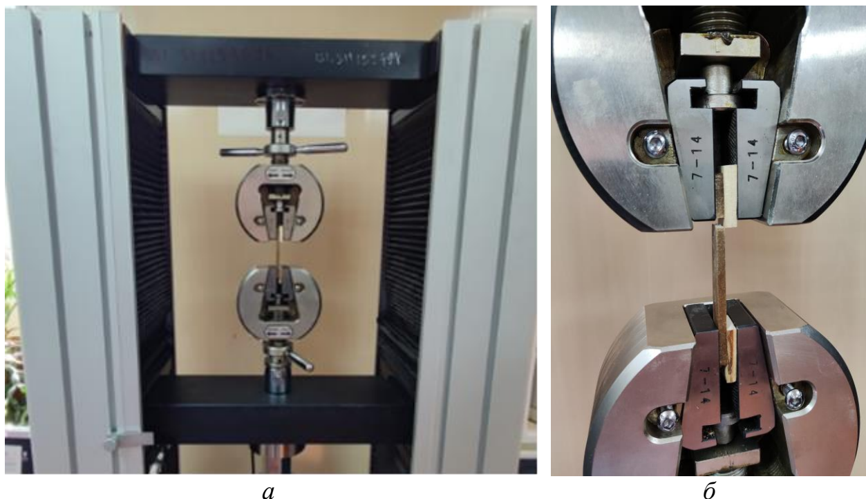
Рисунок 4.11 – Испытание образцов на прочность при разрыве (а); момент разрыва образца (б)
