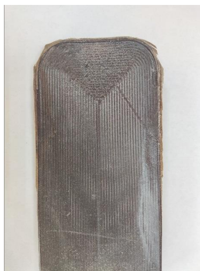
Рисунок 5.7 – Получение опытного образца ДПК на термопластавтомате
