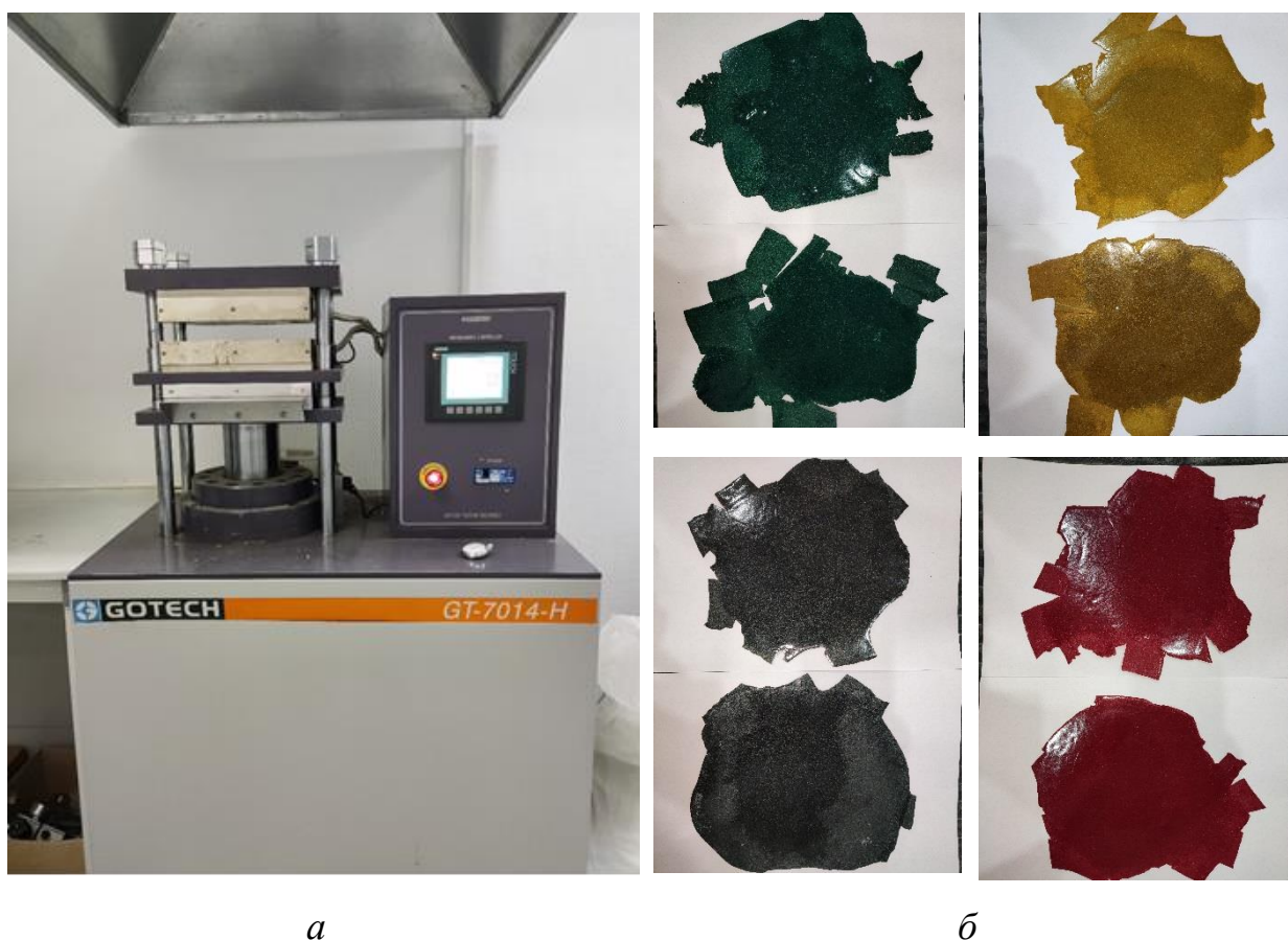
Рисунок 5.2 – Получение образцов композита из ацетилованной и обычной муки с добавлением пигментов
