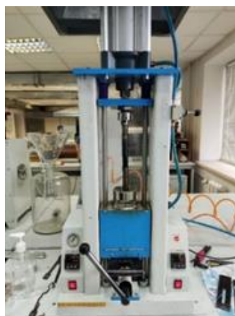
Рисунок 4.6 – Инжекционная литьевая машина для пробоподготовки (a); полученные образцы в виде брусков (б)
