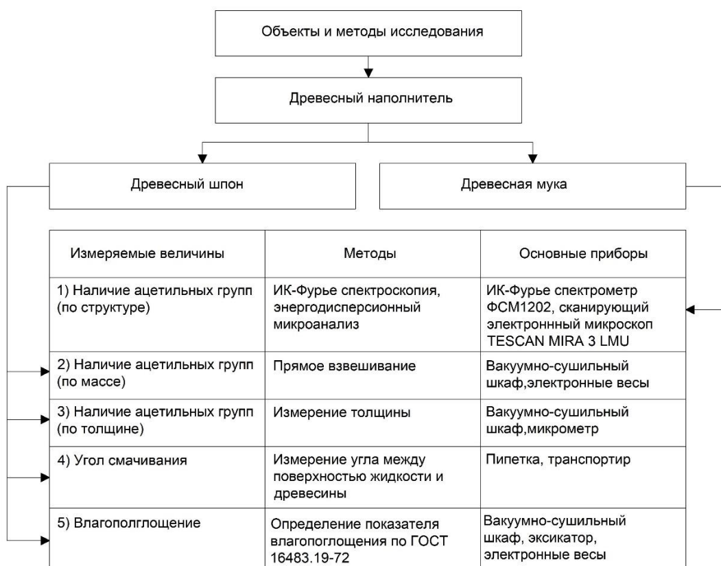
Рисунок 3.3 – Экспериментальные исследования ацетилированной древесины
