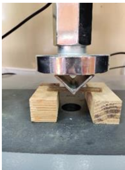
Рисунок 4.12 – Испытание образцов на изгиб
