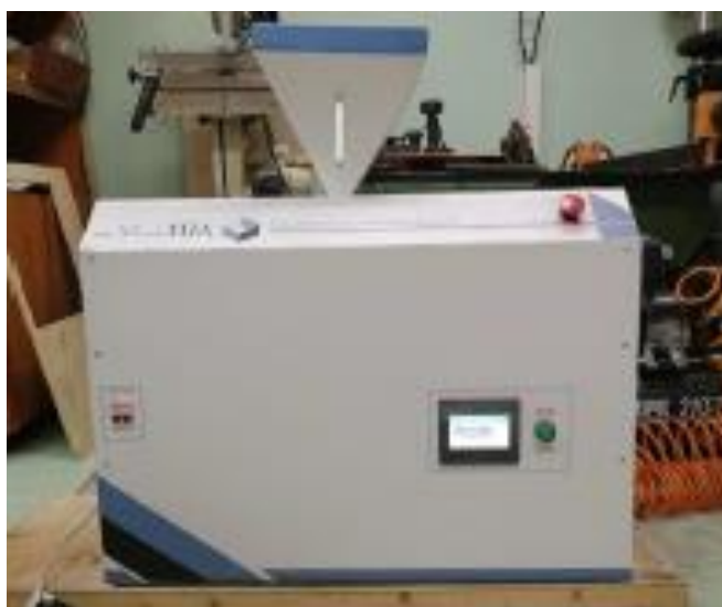
Рисунок 5.7 – Получение опытного образца ДПК на термопластавтомате
