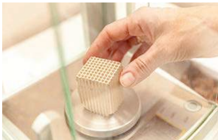
Рис. 3. Этап лабораторного тестирования катализатора подавления оксидов азота
