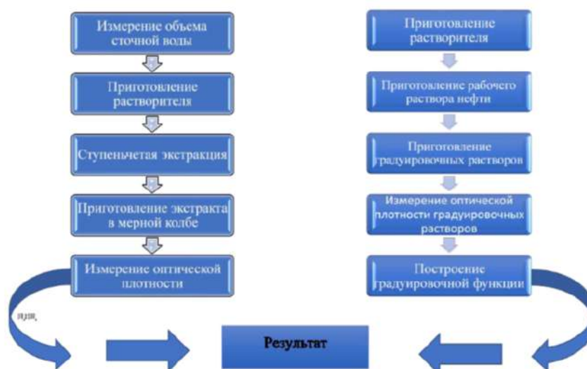
Рис. 1. Блок-схема определения нефти в воде
