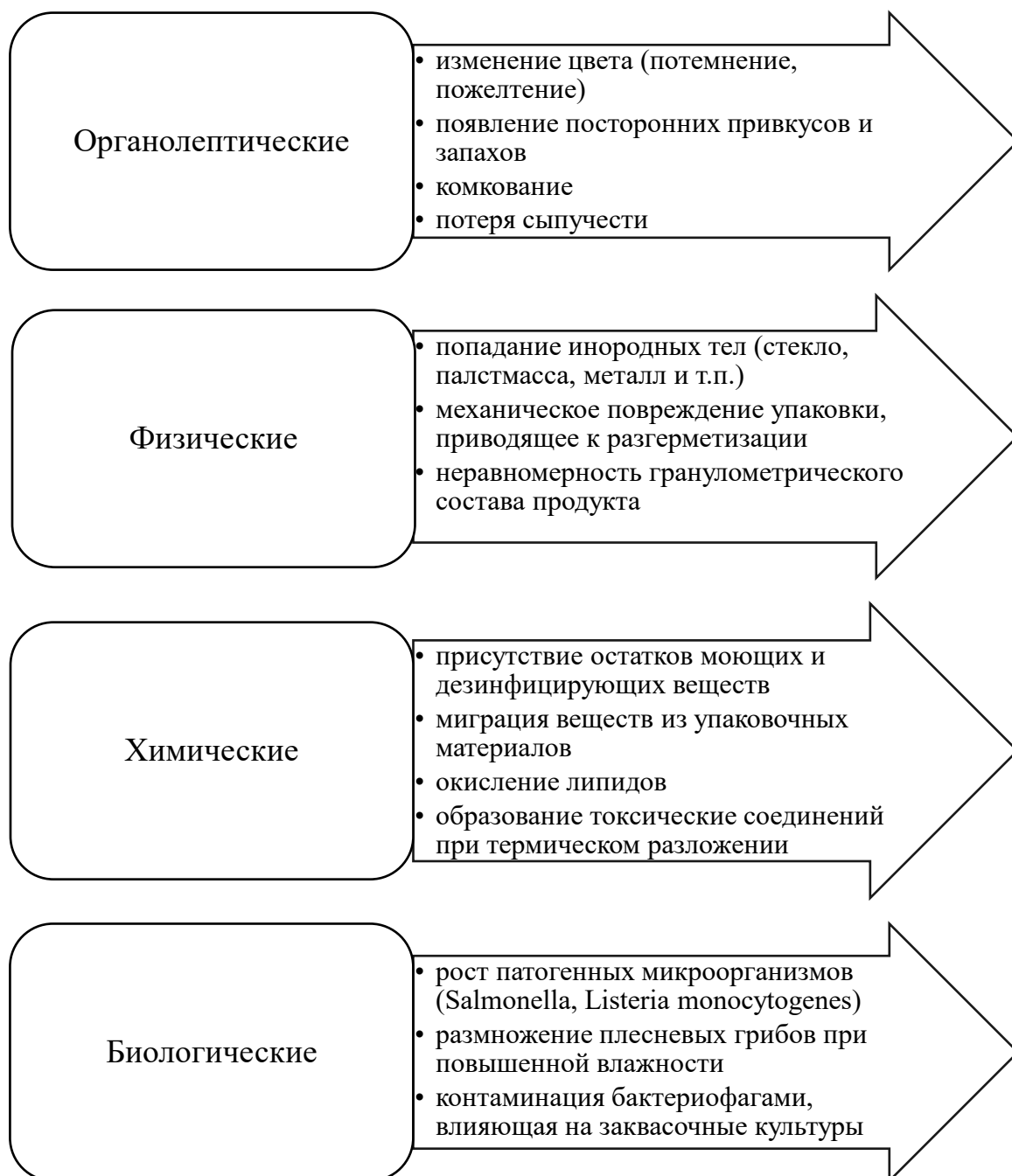
Рисунок 2.2.6 – Структурный состав производственных факторов риска, влияющих на соответствие сублимированной молочной продукции требуемому качеству, по характеру воздействия (составлено автором)
