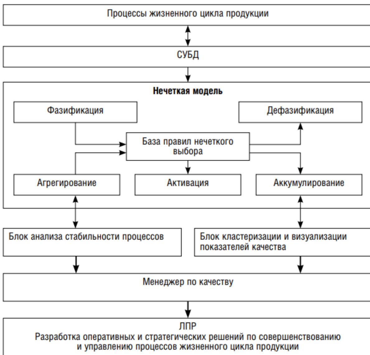
Рисунок 2.1.5 – Блок-схема информационной системы поддержки принятия управленческих решений по вопросам качества производства сублимированного молока [76, С. 51]
