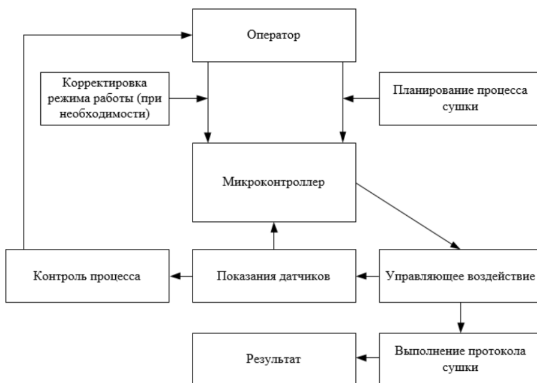
Рисунок 2.2.3 – Алгоритм управления лабораторной экспериментальной установкой сублимации [13, С. 39]
