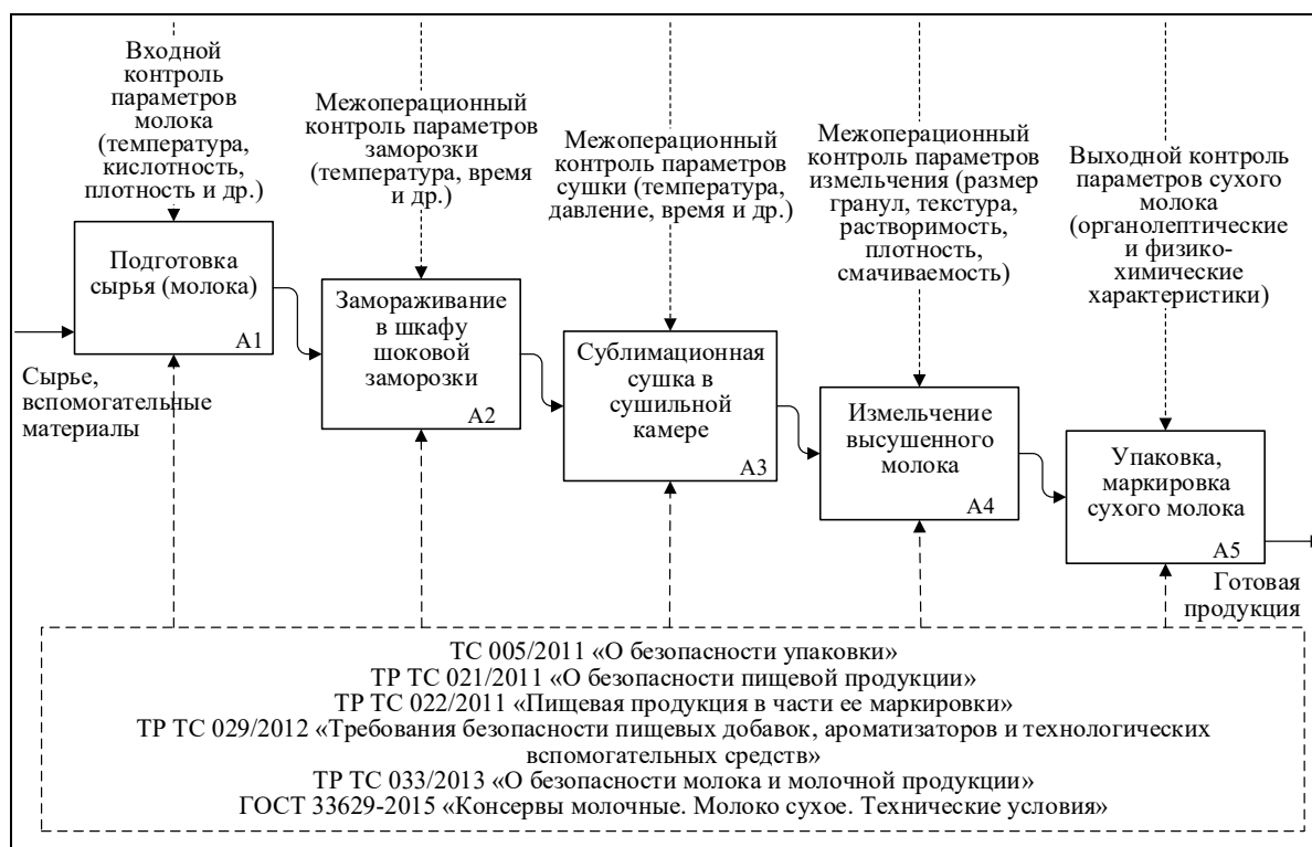
Рисунок 2.3.2 – Организация системы контроля качества на этапах технологического процесса производства сухого молока (разработано автором)
